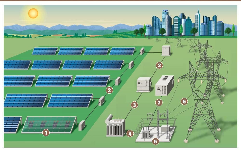
1 SOLAR ARRAY CABLE 2 COLLECTION CABLE 3 POWER EQUIPMENT CABLE 4 MEDIUM VOLTAGE CABLE 5 SUBSTATION CABLE 6 OVERHEAD TRANSMISSION CABLE 7 ENERGY STORAGE
