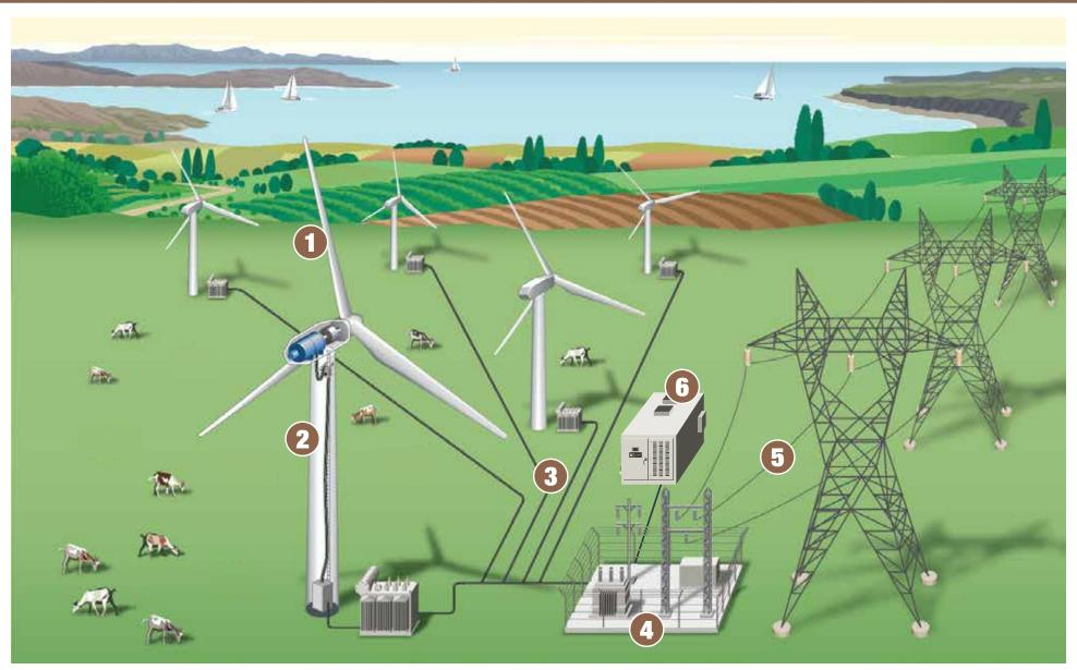
1 BLADE GROUNDING CABLE 2 WIND TOWER CABLE 3 COLLECTION SYSTEM CABLE 4 SUBSTATION CABLE 5 TRANSMISSION CABLE 6 ENERGY STORAGE
